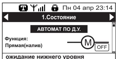
После окончания слива емкости (разомкнулся датчик нижнего уровня или давление ниже минимальной уставки) перед запуском электродвигателя в течение 0,5...1 секунды проверяются следующие параметры:
