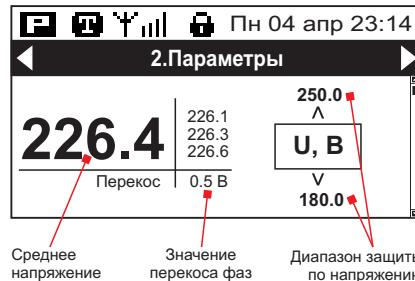
Проконтролировать отображаемые МКЗ значения напряжений можно также при помощи внешнего измерительного прибора. Если показания значительно различаются, возможно выполнить их подстройку. Описание такого режима см. в п. 2.13.3 "Калибровка сигналов".
