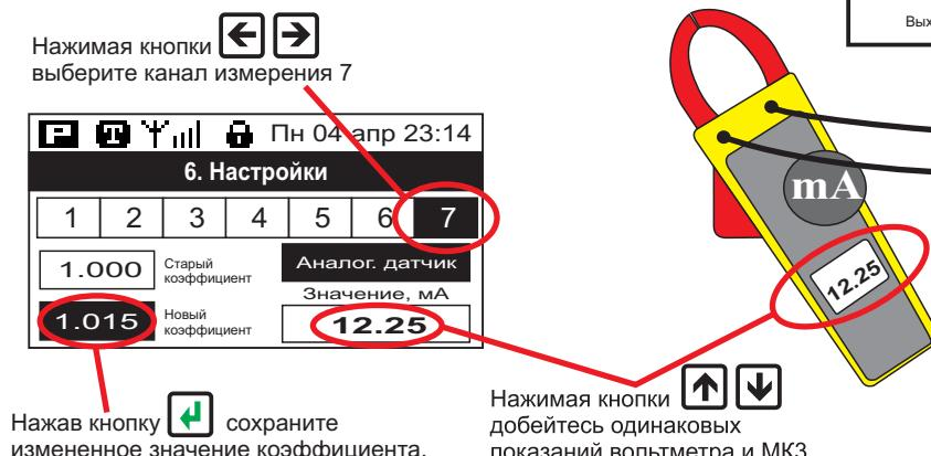
При наличии так называемых калибраторов сигнала (например, РЗУ-420), щупы калибратора подключаются вместо датчика давления(уровня), в калибраторе задается выходной ток и корректируются показания в МК3.
