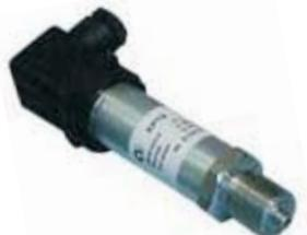
Предназначен для измерения и непрерывного преобразования избыточного давления нейтральных к титану и нержавеющей стали сред (газа, пара, жидкости) в унифицированный выходной сигнал постоянного тока 0...20(4...20)мА. Напряжение питания: 9...30 В, рабочая температура: до -40... +70°C.
