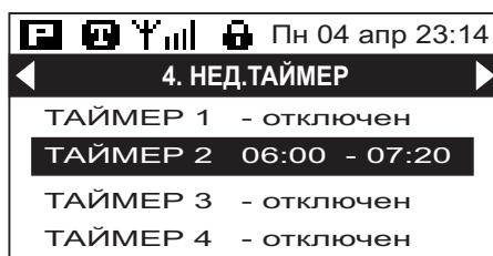
Нажимая кнопки [Влево], [Вправо] перейдите в окно <4.Недельный таймер>. В данном окне выводится состояние и параметры недельного таймера. Доступен просмотр и редактирование четырех программ работы, обозначенных на экране как Таймер 1 - Таймер 4.
