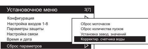
В процессе работы возможно незначительное расхождение показаний физического счетчика и его значений в МК3. Это может быть вызвано, например, выключением питания МК3 при работающем насосе. После выключения питания насос по инерции работает еще некоторое время, в течение которого счетчик может послать импульс уже выключенному МК3. Соответственно, этот импульс не будет посчитан МК3. Следует периодически проводить проверку значений.
