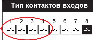
При использовании датчиков с другим состоянием контактов, измените их в этом меню.
