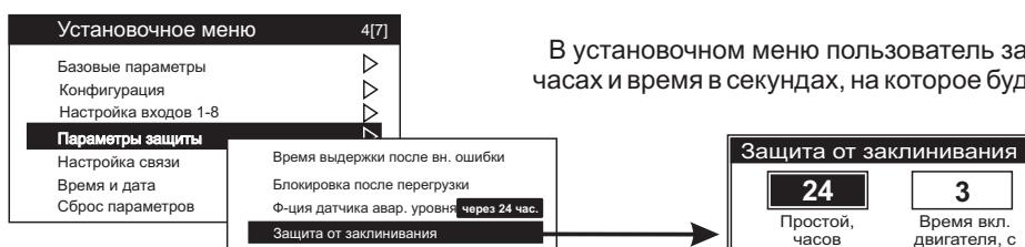
После очередного запуска двигателя МКЗ начинает отсчет времени его простоя. При превышении времени простоя выше заданного, МКЗ кратковременно (на время от 1 до 30 секунд) запускает двигатель. По окончании пуска начинается новый отсчет времени. При этом пуске принудительно отключены защиты по току и напряжению, поэтому рекомендуется устанавливать минимально допустимое время работы для исключения повреждения двигателя или исполнительного механизма.
