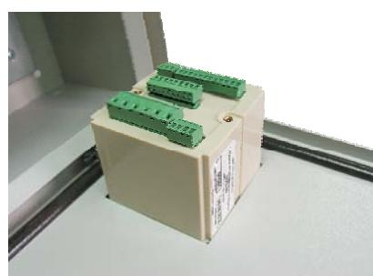
Левую прижимную планку (ближнюю к петлям дверцы) притяните к корпусу вместе с кабельной стяжкой. К ней будет прикреплен жгут после монтажа проводов и кабелей.
