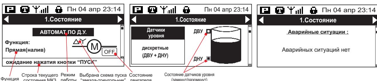
В этом окне при аварийной ситуации будет выведен код и расшифровка аварии, время возникновения, и ожидаемое время сброса данной аварии. Подробнее - см п.2.14 “Аварийные ситуации и индикация ошибок”.
