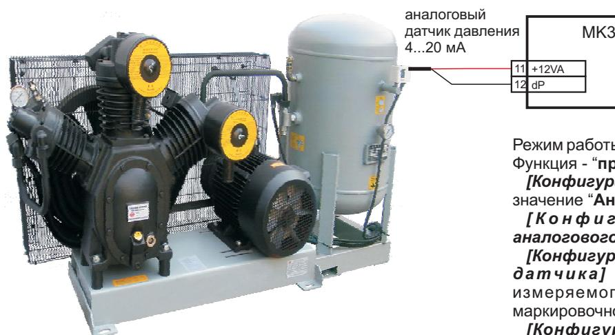
Помимо аналогового датчика, возможно использование дискретных датчиков, например, реле давления. Реле подключается к входу "Внешнее управление" и в установочном меню активируется сигнал "Внешнее управление".
