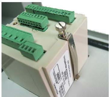
Установите прижимные планки на задней стенке прибора и притяните их к корпусу винтами так, чтобы прибор был плотно прижат к лицевой панели щита. Планки перед установкой слегка выгините внутрь, чтобы при затяжке винтов они не расходились в стороны.
