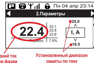
Зайдите в установочное меню и установите значение параметра "Максимальный ток" на 10...15% больше среднего значения, которое Вы запомнили, а значение параметра "Минимальный ток" на 10...15% меньше. Это будут границы срабатывания защиты при перегрузке или недогрузке двигателя.
